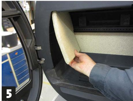
**5** Ajuste la placa lateral en la parte superior
