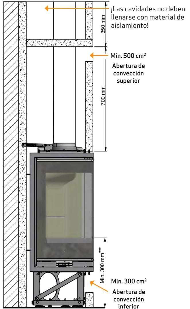
La distancia al muro cortafuegos (ladrillo) depende del uso de un tubo de tiro aislado de aislamiento en toda su longitud hasta el encastre
