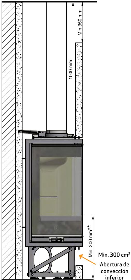
Instalación con tubo de humos vertical aislado
