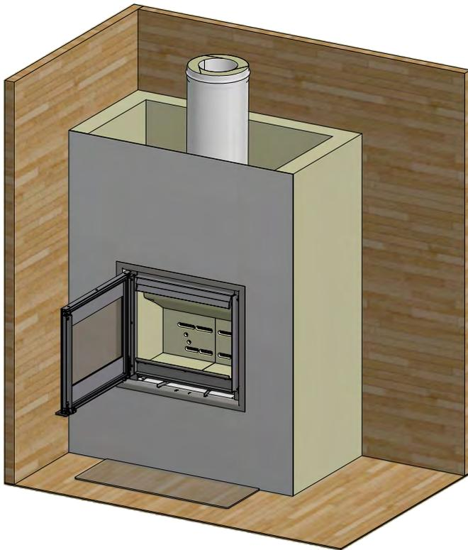
Cuando construya o monte una estructura/cerco con abertura en la parte superior, puede omitir los agujeros de convección. No obstante, deberá tener en cuenta no colocar ninguna placa superior sobre la estructura
