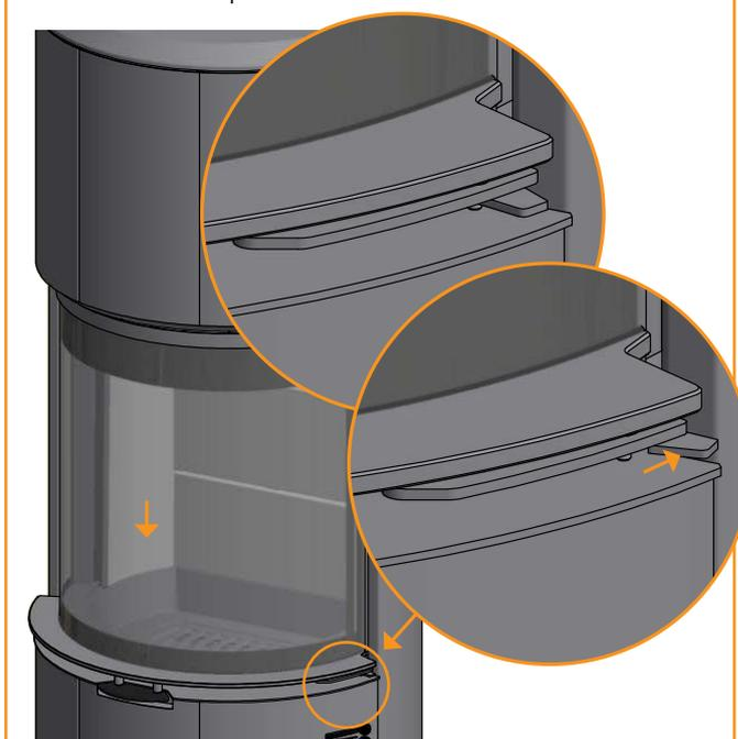
3 Tire de la maneta para abrir la puerta lateralmente y poder limpiar la parte interior del cristal. Recuerde volver a montar la puerta siguiendo el mismo proceso a la inversa
