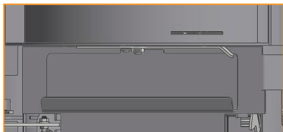
Contenedor de ceniza en posición cerrada
