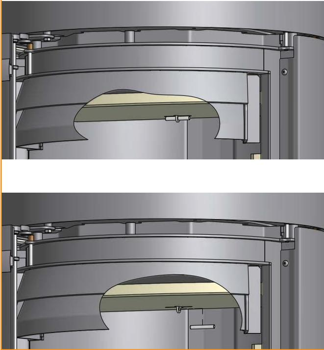
La pieza de sujeción de la placa deflector puede caer al sacar la placa deflector de la estufa de leña. Vea las siguientes ilustraciones para conocer el procedimiento
