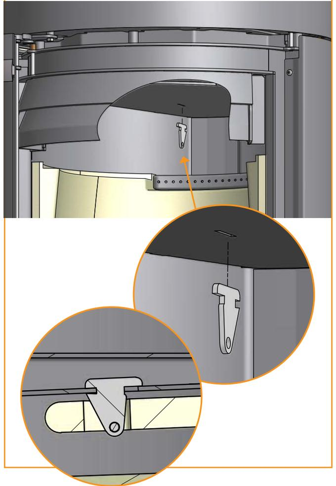
Deslice en primer lugar el extremo de la placa deflector y bájela a través de la cámara de combustión
