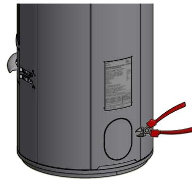
Si desea que entre el aire de combustión externo por la pared, retire la placa de cubierta de la parte posterior de la estufa con unos alicates de corte
