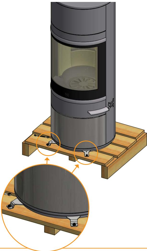
Retire los tornillos y las fijaciones que sujetan la estufa al palé
