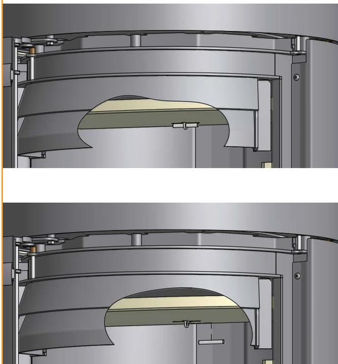
La pieza de sujeción de la placa deflector puede caer al sacar la placa deflector de la estufa de leña. Vea las siguientes ilustraciones para conocer el procedimiento
