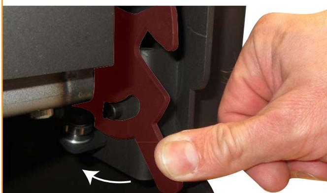
Coloque de nuevo la placa de cubierta
