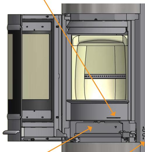
Cajón de cenizas      Ajuste del suministro de aire, regulador de primario y secundario
