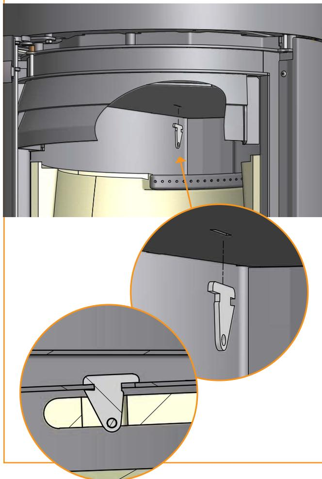
Deslice en primer lugar el extremo de la placa deflector y bájela a través de la cámara de combustión
