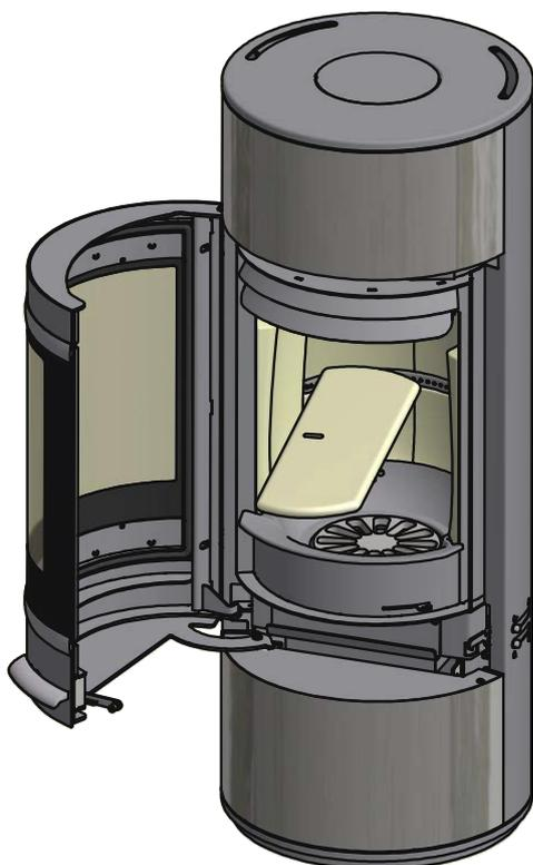
Levante con cuidado los laterales y las placas traseras del revestimiento de la cámara de combustión y sáquelos de la estufa
