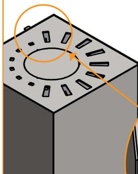
Rejilla de convección en posición cerrada para reforzar la acumulación de calor
