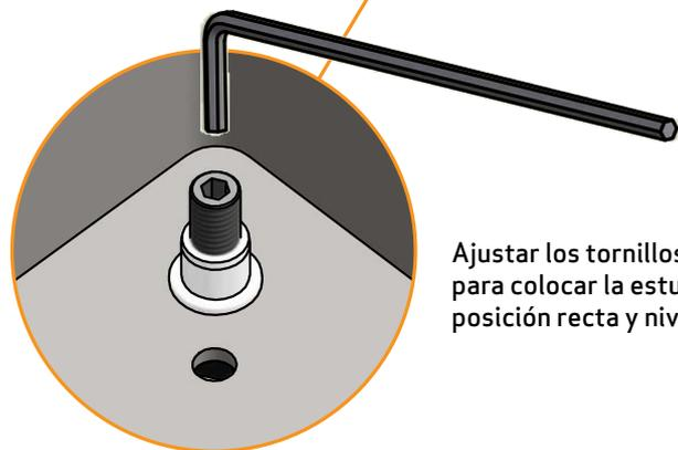
Ajustar los tornillos de ajuste para colocar la estufa en posición recta y nivelada
