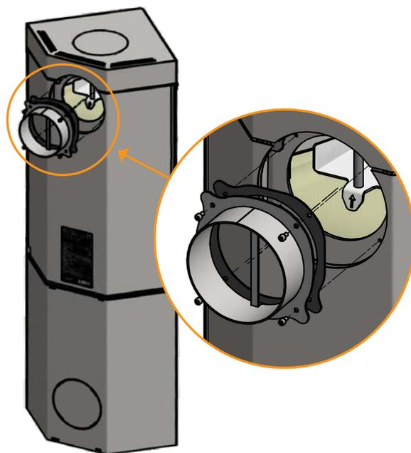
2 Retire la cubierta de la salida posterior de la estufa.
