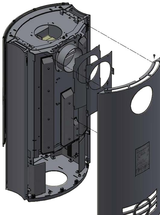
Instalar la junta sobre la pieza de conexión
