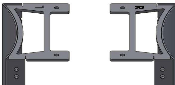
1. Asegure el soporte inferior lateral con 2 tornillos
