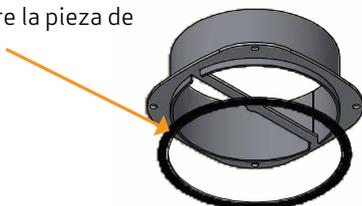
Colocar la pieza de conexión con los cuatro tornillos
