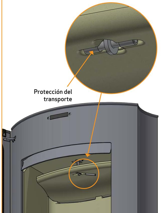
3 Levante la placa deflector superior y retire la protección
