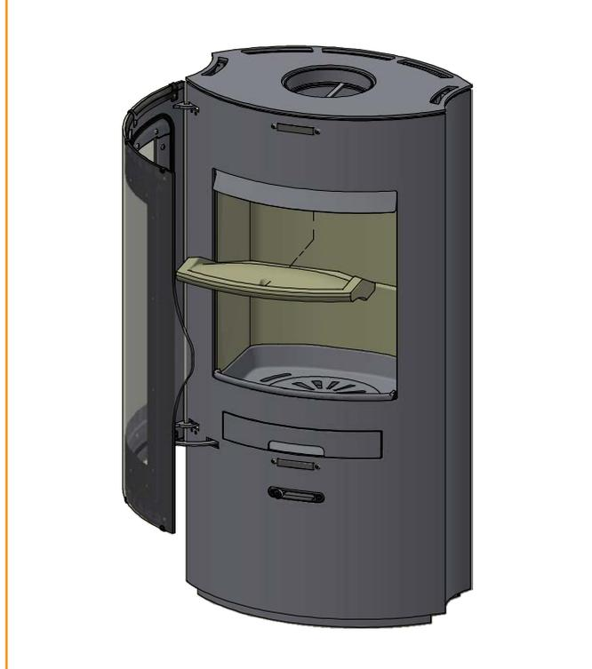
4 Monte la placa deflector superior con su correspondiente pin y placa deflector inferior reensamblado después
