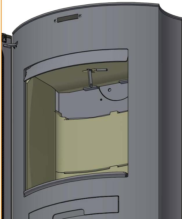
Deslice en primer lugar el extremo de la placa deflector y bájela a través de la cámara de combustión
