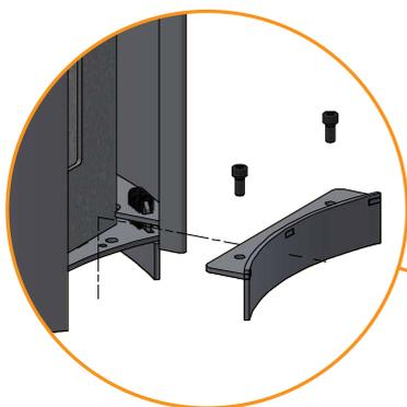
2. Fije las placas laterales con 2 tornillos en la parte superior
