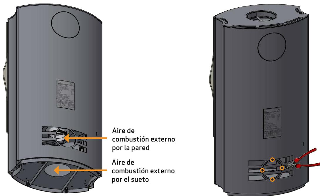
Si desea que entre el aire de combustión externo por la pared, retire la placa de cubierta de la parte posterior de la estufa con unos alicates de corte
