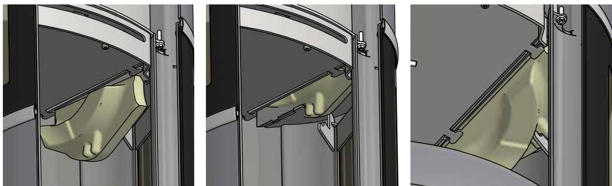
Cuando las placas de vermiculita 1-4 estén colocadas, se deberían ver así. Asegúrese de que los dos deflectores están colocados idénticamente
