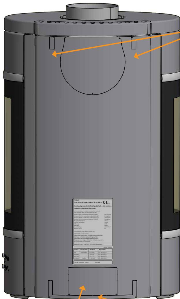
Deben retirarse, incluso en el escudo de calor, para el montaje en pared
