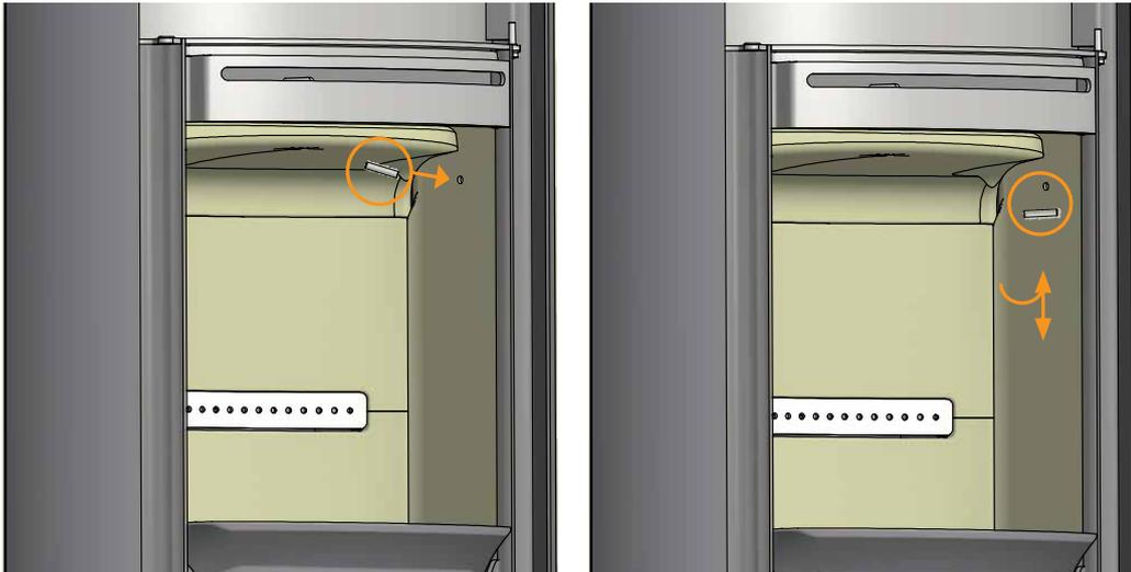
Extraiga el pasador de la placa deflectora de humos superior, levante y retire la placa lateral y extraiga la placa deflectora.
