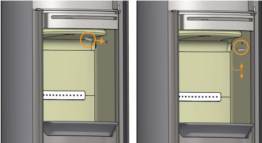
Extraiga el pasador de la placa deflectora de humos superior, levante y retire la placa lateral y extraiga la placa deflectora.
