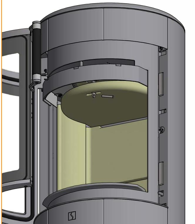
3 Levante la placa deflector superior y retire la protección
