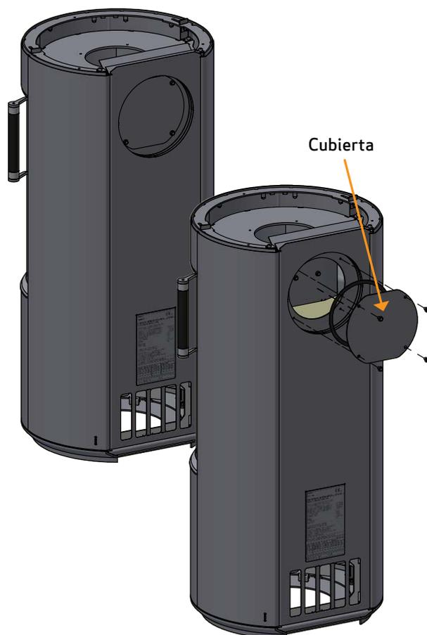
Utilizando unos alicates, corte los puntos de sujeción de la placa de cubierta
