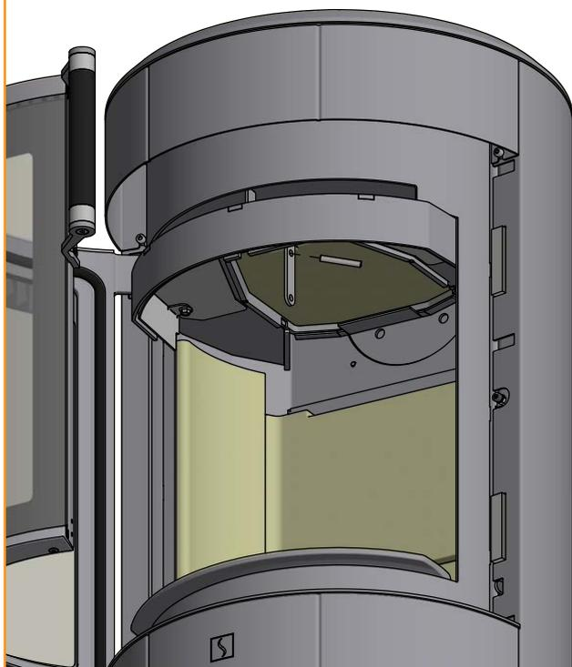
Deslice en primer lugar el extremo de la placa deflector y bájela a través de la cámara de combustión
