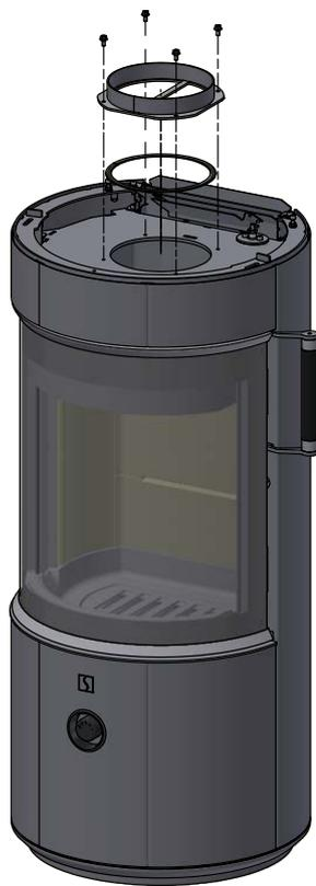
Retire la cubierta de la salida posterior de la estufa.
