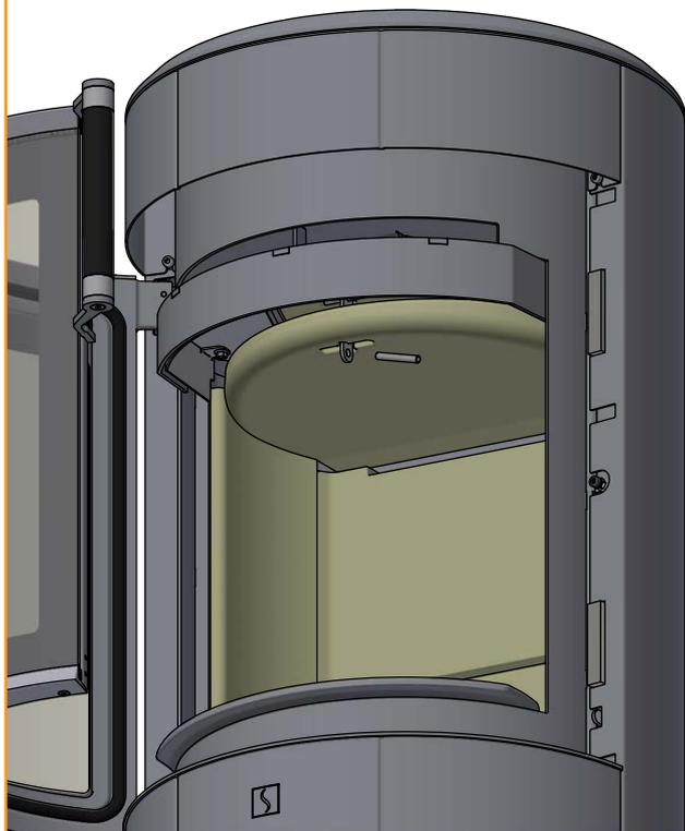
3 Levante la placa deflector superior y retire la protección
