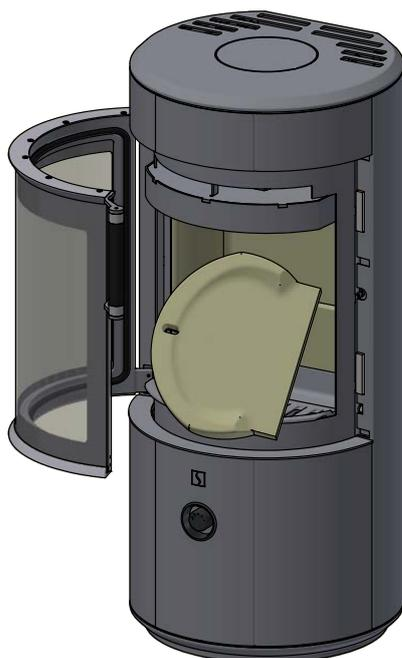
4 Monte la placa deflector superior con su correspondiente pin y placa deflector inferior reensamblado después
