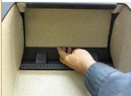
Presione la placa un poco hacia atrás de modo que se apoye sobre el carril en la parte trasera
