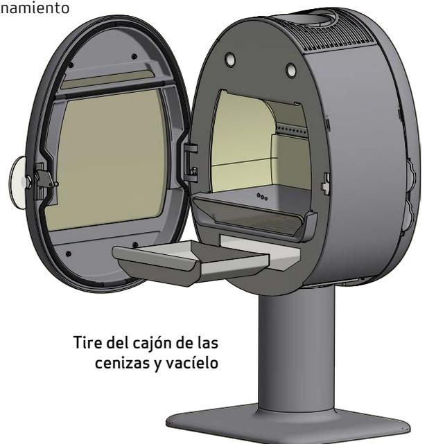
**Tire del cajón de las cenizas y vacíelo**
