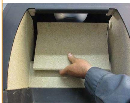
Presione la placa hacia arriba de modo que quede apoyada sobre la placa frontal
