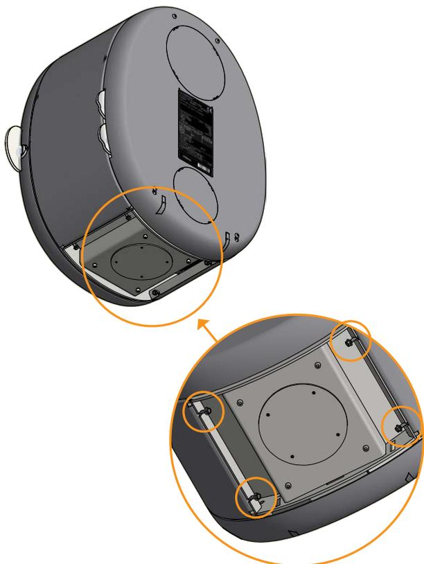
Apriete la pieza de conexión de la chimenea utilizando los tornillos suministrados
