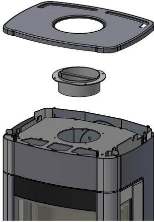
2 Instalar la junta sobre la pieza de conexión
