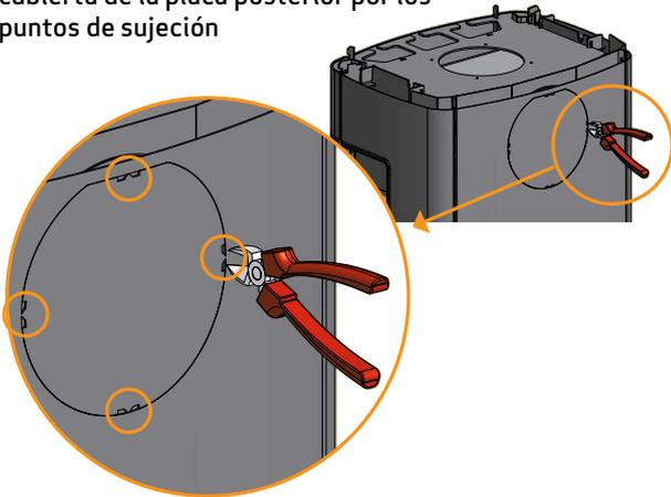
4 Levantar el escudo de calor de la estufa y utilizar unos alicates de corte para cortar la placa de cubierta por los puntos de sujeción y retírela
