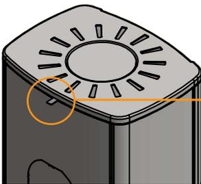
La válvula para el ajuste del aire de convección se coloca en la parte trasera de la parte superior alta
