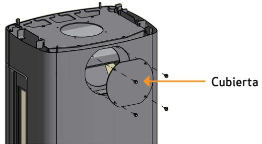
6 Colocar la pieza de conexión con los cuatro tornillos que hay en el cajón de las cenizas. Acoplar el escudo de calor en la estufa
