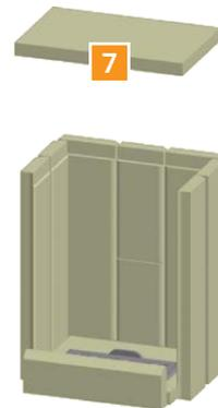
Coloque los soportes de la placa deflectora inferior #6a y #6b en el borde de las placas refractarias #3a, #3b, #3c, #3d, #4a y #4c. Coloque ahora el deflector inferior #5. Asegúrese de que las dos piezas deflectoras se colocan por igual
