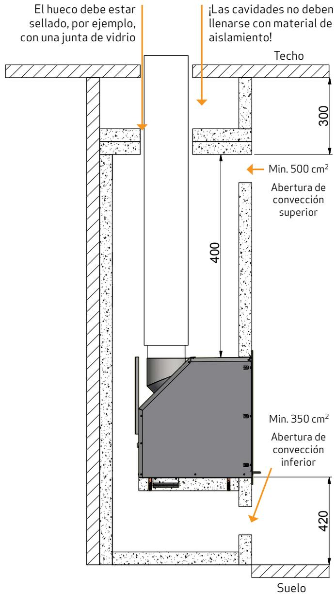
La distancia al muro cortafuegos (ladrillo) depende del uso de un tubo de tiro aislado de aislamiento en toda su longitud hasta el encastre
