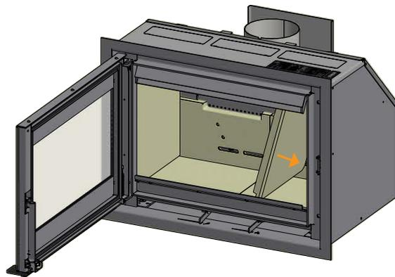
Monte la placa deflectora de humo inferior. La placa deflectora debe quedar sujeta por las placas traseras. Coloque los pasadores y ponga el deflector de humo en su sitio
