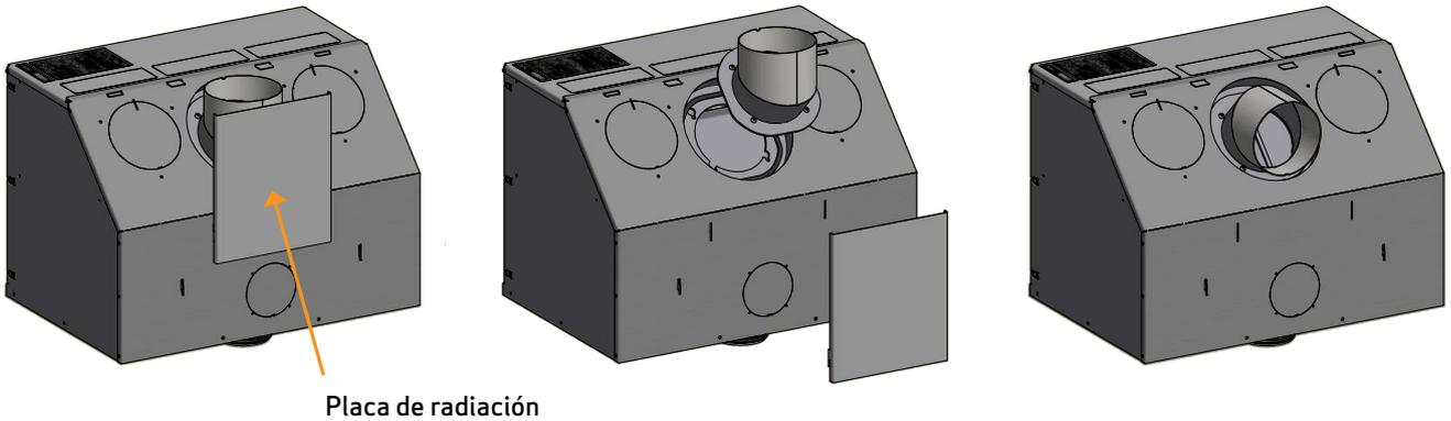
Coloque la junta de 3 x 8 mm en el borde de la pestaña de la pieza de conexión. Fije la pieza de conexión con las tuercas de pestaña
