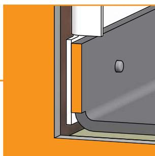
Los puntos de ajuste de las cuatro esquinas de la cassette deben estar a nivel con la parte delantera del cerco
