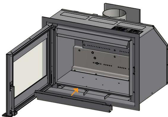
Coloque las piedras inferiores con el borde inclinado vuelto hacia atrás y hacia abajo
